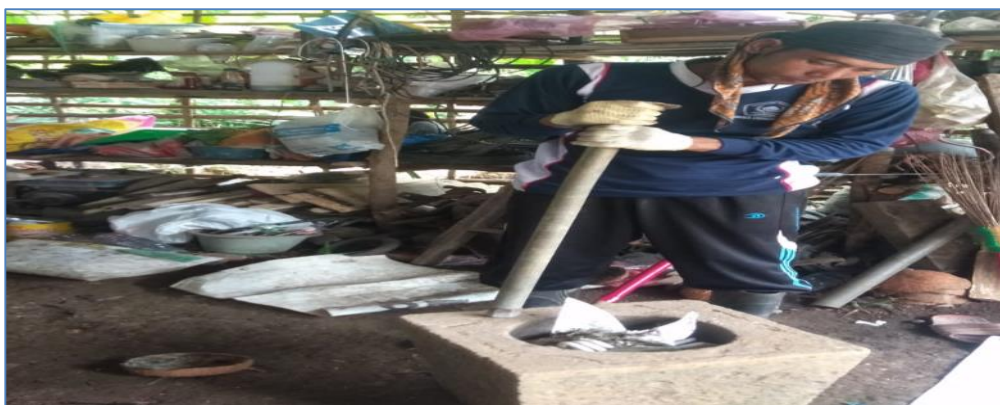
Gambar 3. Proses penghancuran beling/ kaca
