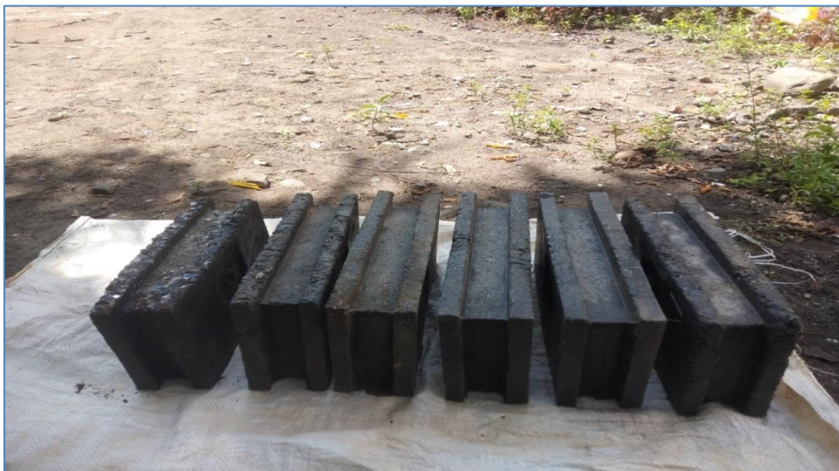
Gambar 5. Batako plastik campuran beling
